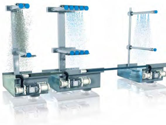
Das Wärmerückgewinnungssystem wird automatisch gereinigt, um seinen maximalen Wirkungsgrad zu gewährleisten. Durch die effektive Selbstreinigung wird der manuelle Aufwand deutlich reduziert. Dies führt zu stabilen Hygienebedingungen in der Maschine und deutlich geringeren Betriebskosten.
