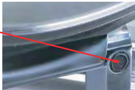
Zulauf über Perlator im Deckeldrehgelenk
